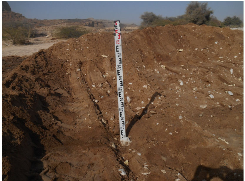
شكل رقم (٧-٨) عمق منطقة التسرب الثانية بالجانِب الأيمن لوادي حبان
