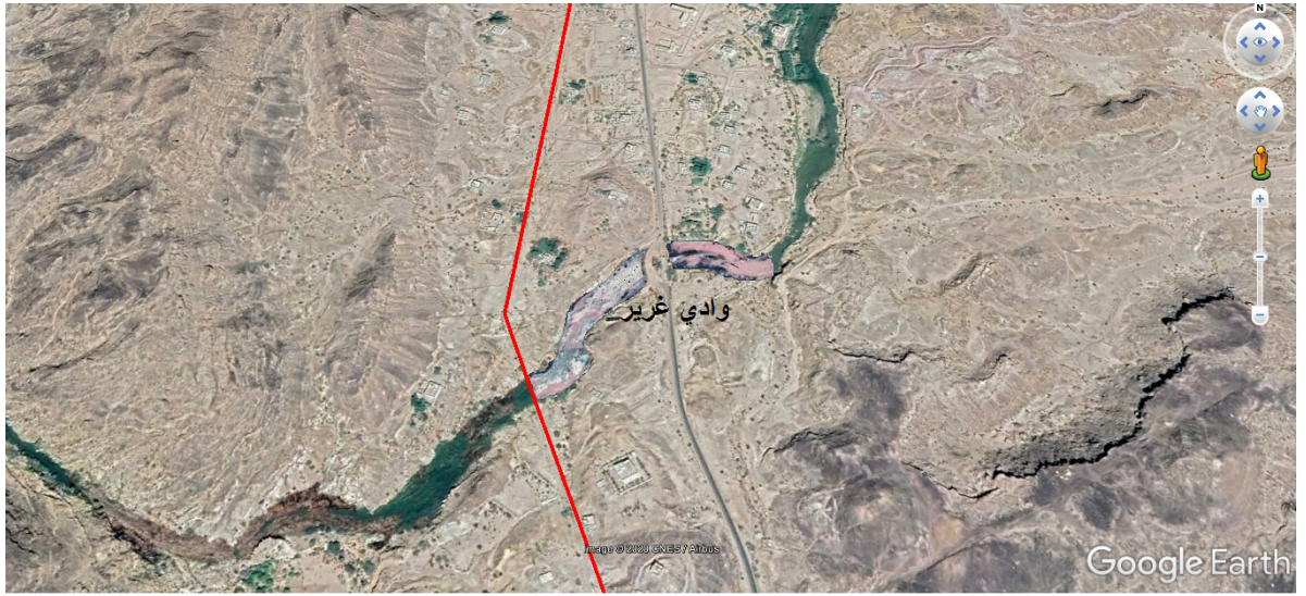
شكل (٦-٢) يوضح مسار الانبوب النفطي المار بوادي غير وامتداد التلوث النفطي
