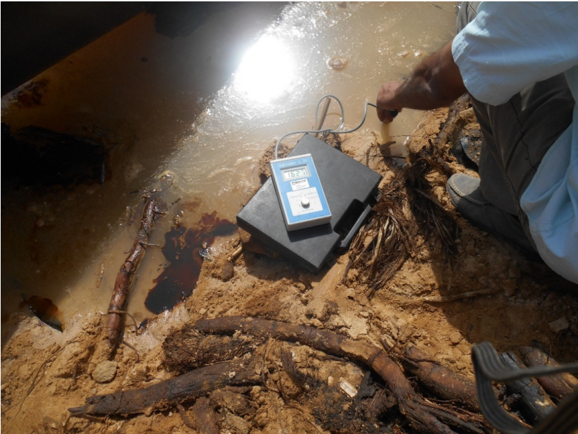
شكل (٦-١٠) يوضح جهاز التوصيلة الكهربائية (E.C) للمياه
