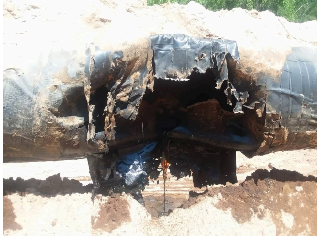
صورة 2-1 أنبوب نفط تعرض للتفجير في احد المواقع في خط الانبوب - شبوة
